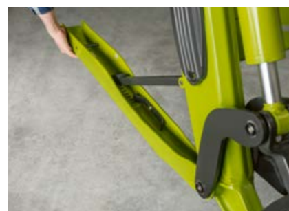
Wsporniki składają się pod ramieniem i dzięki temu nie ograniczają widoczności ładowacza czołowego.
