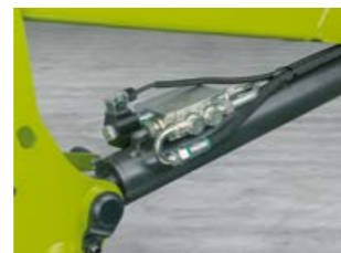
Dzięki elektrycznemu przelączeniu w serii FL i FL C zawory zabezpieczające można połączyć z tłumieniem wstrząsów SHOCK ELIMINATOR.
