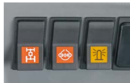
Elektroniczne włączanie napędu wszystkich kół i blokady mechanizmu różnicowego: wyłączenie zależne od prędkości jazdy eliminuje błędy w obsłudze.
