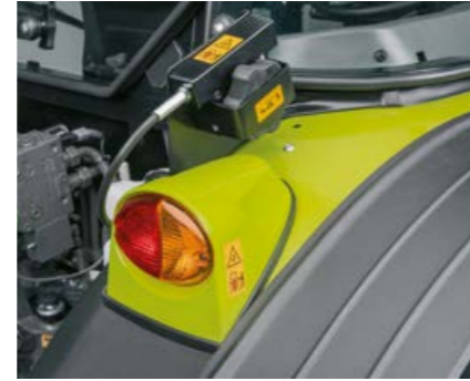
Mechaniczny tylny podnośnik podczas dołączania maszyn można obsługiwać z zewnątrz.
