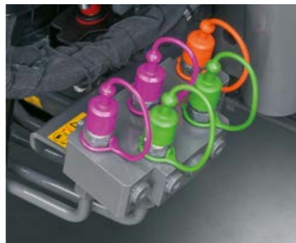
Z przodu z prawej strony kabiny dostępne są maksymalnie cztery przyłącza hydrauliczne oraz jeden swobodny powrót.
