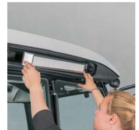
Filtr powietrza kabiny jest łatwo dostępny z zewnątrz do czyszczenia i zawsze zapewnia świeży klimat w kabinie.
