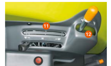
Włączanie WOM jest seryjnie wspomagane hydraulicznie. W maszynach wyposażonych w REVER-SHIFT opcjonalnie dostępne jest elektroniczne włączanie WOM.
