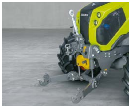
Opcjonalny przedni podnośnik o udźwigu 3,2 t oraz przedni WOM rozszerzają spektrum zastosowań ELIOS.
