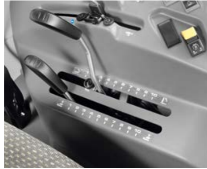
Elementy obsługi mechanicznej regulacji tylnego podnośnika umieszczono w ergonomiczny sposób z prawej strony fotela operatora.
